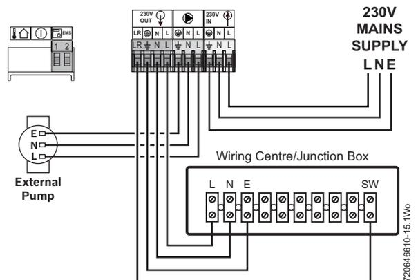
Fig. 41 System wiring centre
