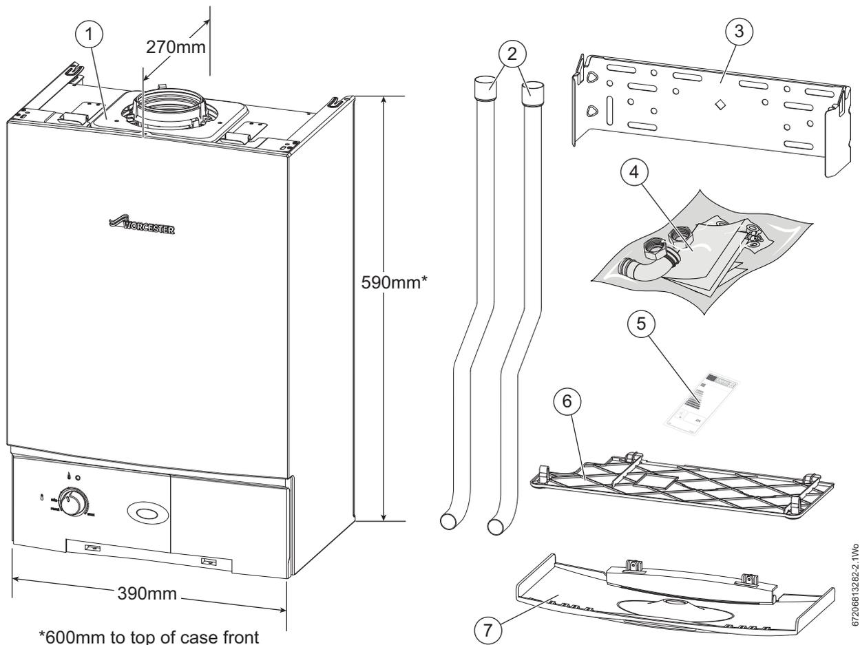
Fig. 1 Ri Compact<sup>ErP</sup> standard package
