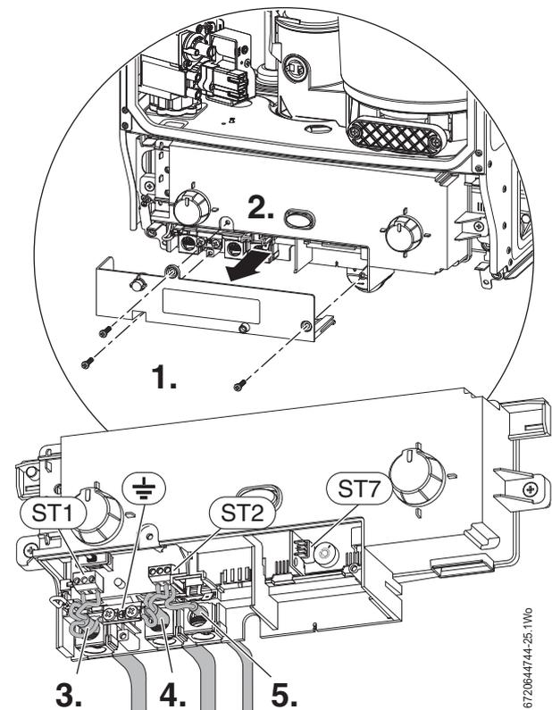
Fig. 39 Wiring detail
