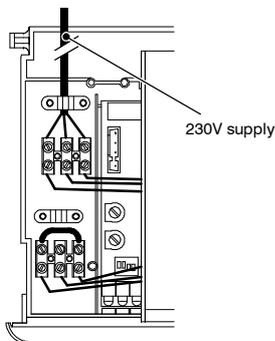
**ELECTRICAL CONNECTIONS FOR A COMBI BOILER**
